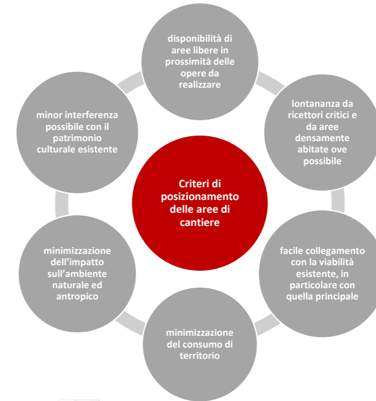
Figura 94: Criteri di posizionamento delle aree di cantiere
