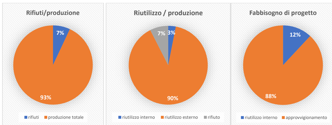
Figura 1. Dettaglio Gestione dei Materiali da scavo
