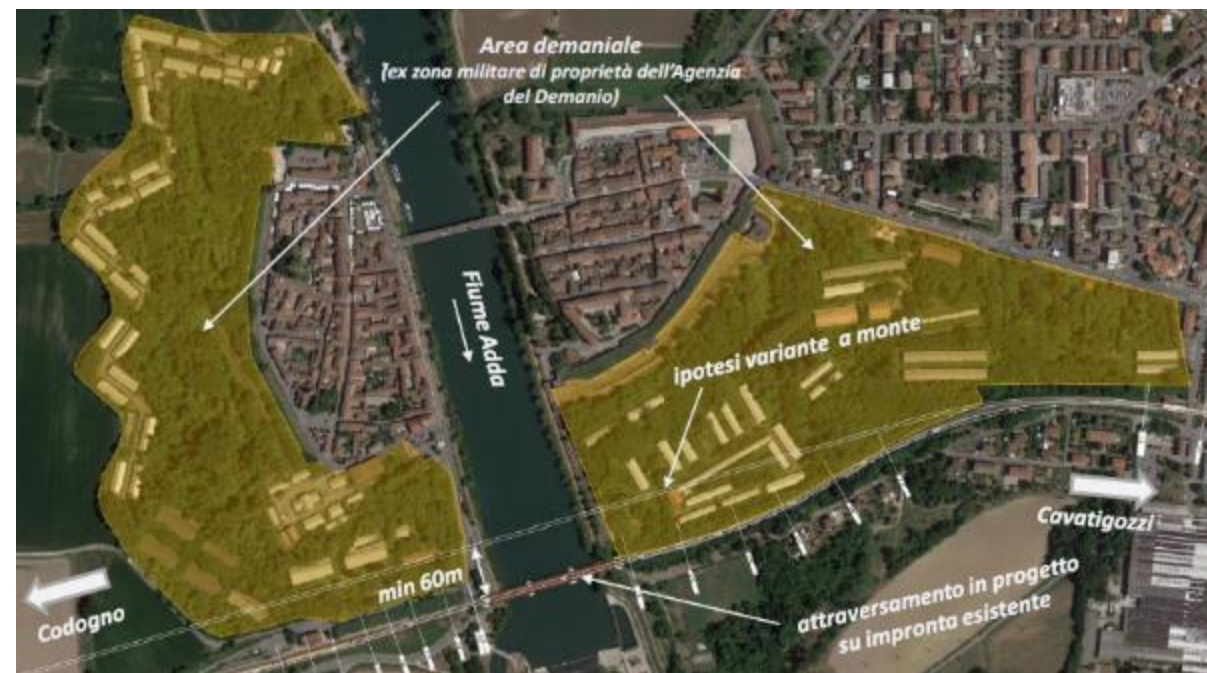
Figura 3-11 -VI01 – Viadotto sul fiume Adda a Pizzighettone in progetto: ipotesi variante di tracciato a monte del ponte esistente (interferenza area demaniale)
