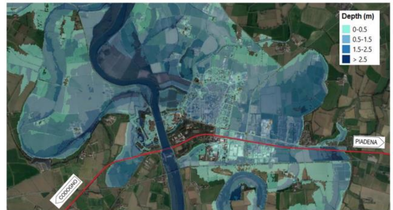
Figura 3-21 - Modello numerico 2D del Fiume Adda: aree potenzialmente inondabili, post operam (Tr200 Fiume Adda + Tr100 del Fiume Po)
