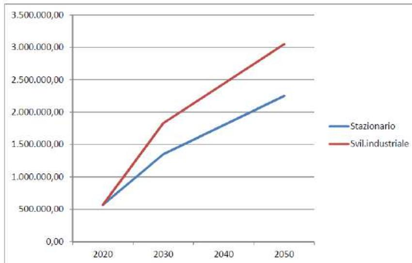
**Figura 24 - Visualizzazione di un possibile sentiero di crescita della domanda ferroviaria sull'infrastruttura al 2050 (tonnellate anno) nelle ipotesi di stato stazionario (linea blu) e di crescita dell'insediamento industriale (linea rossa); fonte: elaborazione a cura di Vittorio Torbianelli.**
