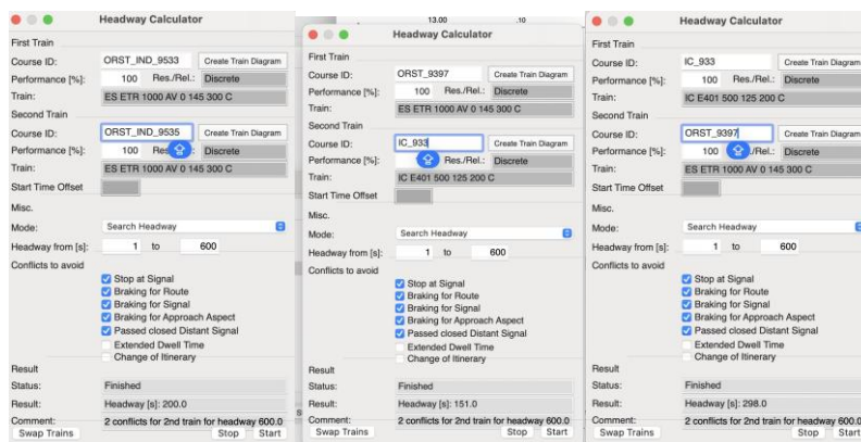
Figura 5 – Esempio di calcolo dell’headway minimo per coppie di treni in successione 1Â°Biv.Orte Sud - BSTT
