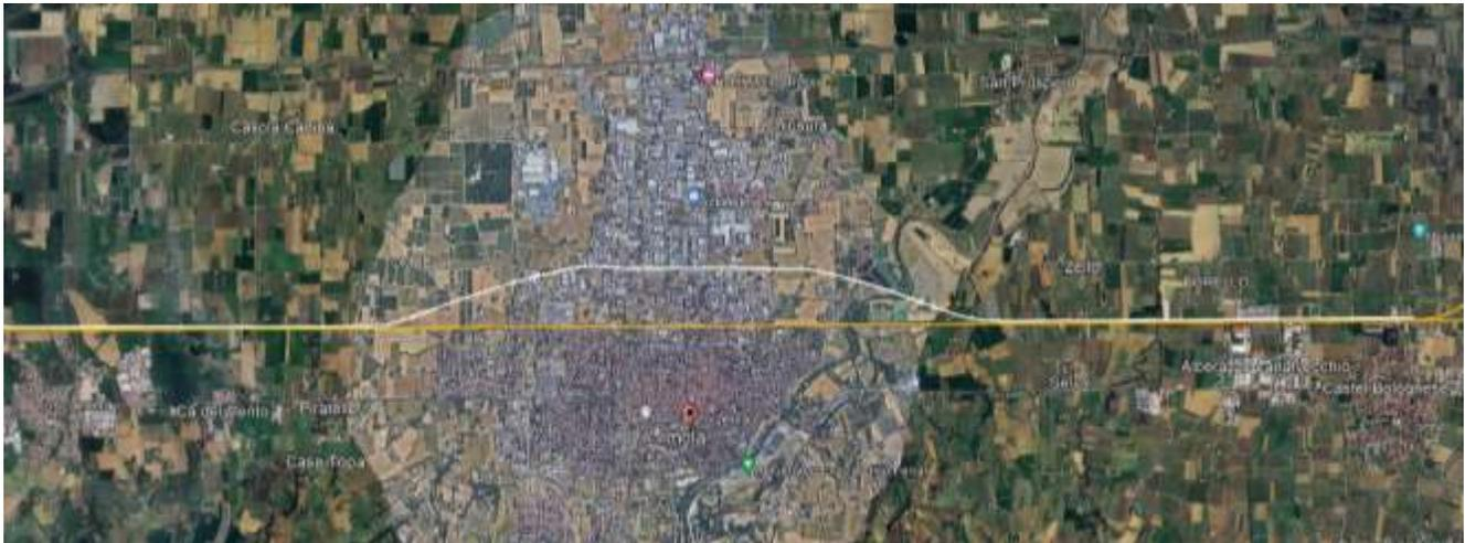
Nella grafica sopra riportata, si propone l'attraversamento della città di Imola con un PASSANTE FERROVIARIO SOTTERRANEO, che viaggia a ridosso dell'attuale sedime ferroviario, allontanandosi in corrispondenza dell'abitato di Imola per evitare viadotti, abbattimenti di manufatti, abitazioni ed imprese.
