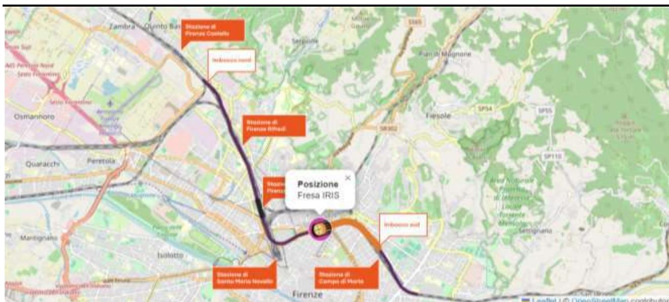
Per il sottoattraversamento saranno scavate a circa 20 metri di profondità due gallerie parallele, una per ogni senso di marcia, ciascuna lunga circa 7 chilometri, con un diametro di oltre 9 metri e collegate tra loro con by pass di sicurezza ogni 500 m, tra la stazione di Firenze Campo di Marte e la zona del viale XI Agosto, situata fra le stazioni di Firenze Rifredi e di Firenze Castello.
