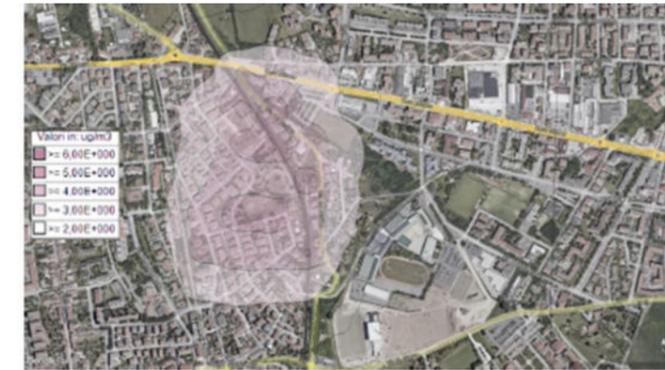
Figura 6-44 Concentrazioni di PM<sub>10</sub> dovute alle emissioni dei mezzi d'opera per il secondo scenario di simulazione (cantiere operativo e area stoccaggio)
