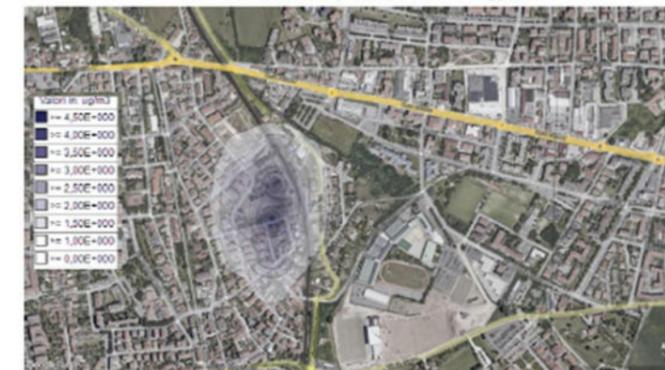
Figura 6-45 Concentrazioni di NO<sub>x</sub> dovute alle emissioni dei mezzi d'opera per il secondo scenario di simulazione (cantiere operativo e area stoccaggio)
