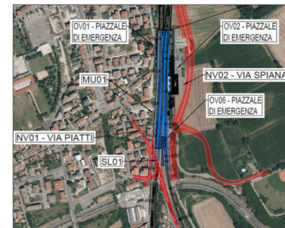
Figura 35 - Viabilità di progetto Via Piatti - Via Spianà - Via Sogare
