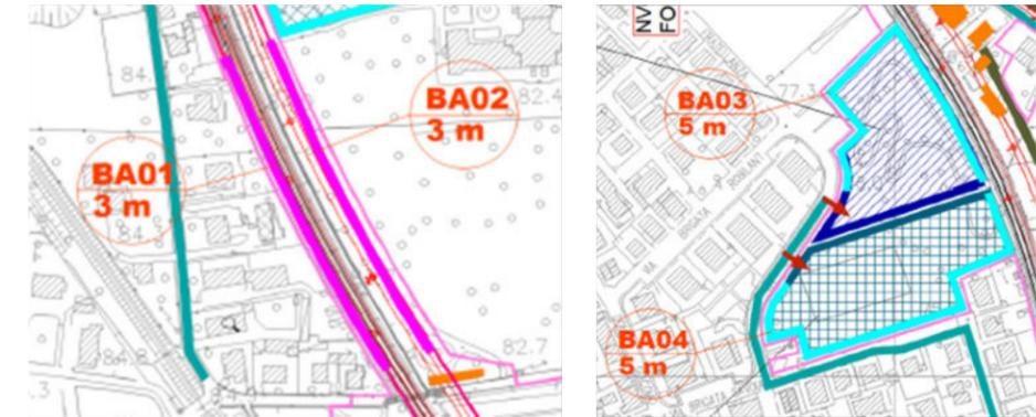
Figura 106 - Individuazione delle barriere negli scenari valutati
