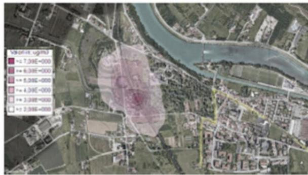
Figura 6-42 Concentrazioni di PM<sub>10</sub> dovute alle emissioni dei mezzi d'opera per il primo scenario di simulazione (cantiere mobile)
